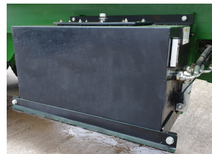
Deposito auxiliar aceite*
