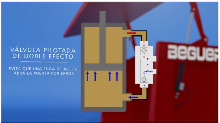
VÁLVULA PILOTADA DE DOBLE EFECTO
