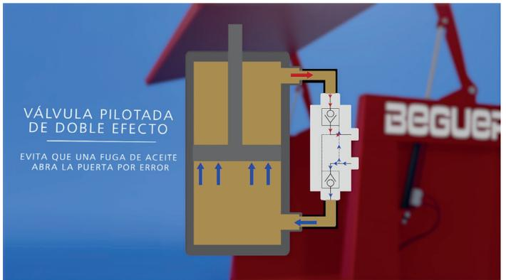
VÁLVULA PILOTADA DE DOBLE EFECTO
